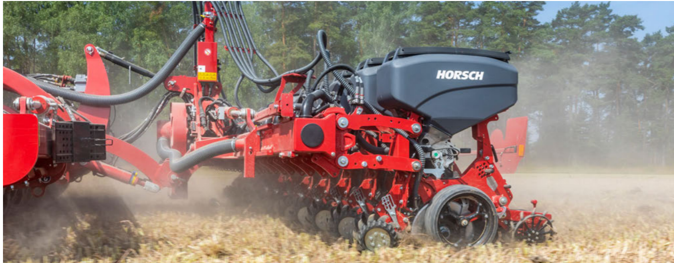
Dzięki połączeniu z wozem nasiennym siła nacisku redlic może wynosić do 350 kg
