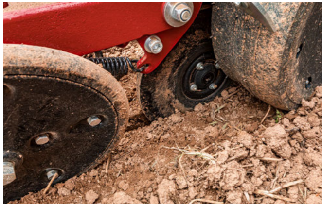
Rolka pozycjonująca jest decydująca dla dobrego kontaktu z glebą
