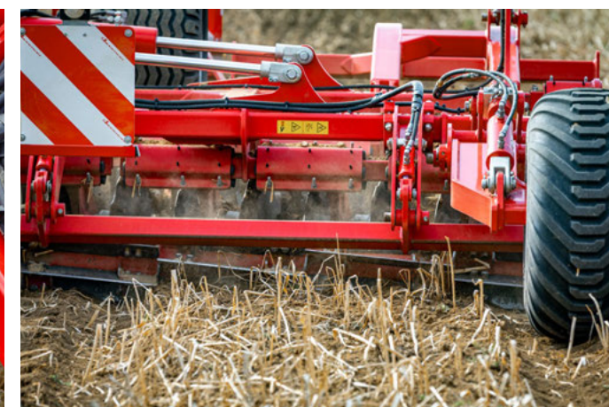
Wał nożowy zapewnia dodatkowe rozdrabnianie
