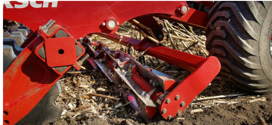
Wał nożowy dla brony Joker 5-8 RT Hydraulicznie wstępnie naprężony wał nożowy zapewnia dodatkowy efekt rozdrabniania.
